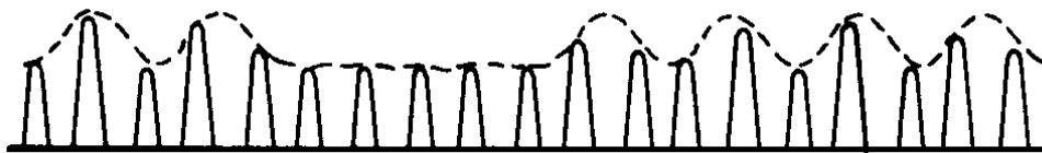
(D) RECTIFIED MIXED - FREQUENCY SIGNAL
